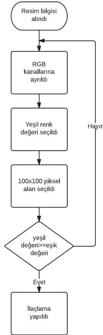
Şekil 5- Sıra arası yabancı ot ilaçlamasına ait akış diyagramı (Sabancı 2013)
