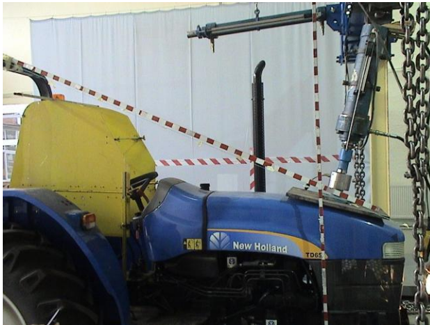
Şekil 4. Güvenli koruma bölgesi ve yer düzlemini temsil eden çubuğun durumu
