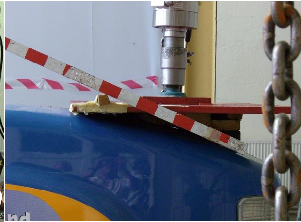
Şekil 5. Yer düzlemine göre dik yapılan yükleme
