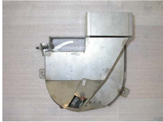
Şekil 2. Dikim ünitesi kapağı (Ünal ve Keskin 2005)
